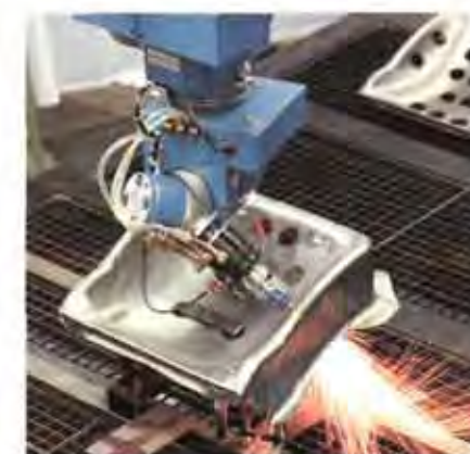
... des 1000-Watt-Lasers entlang der programmierten Linie schneidet
