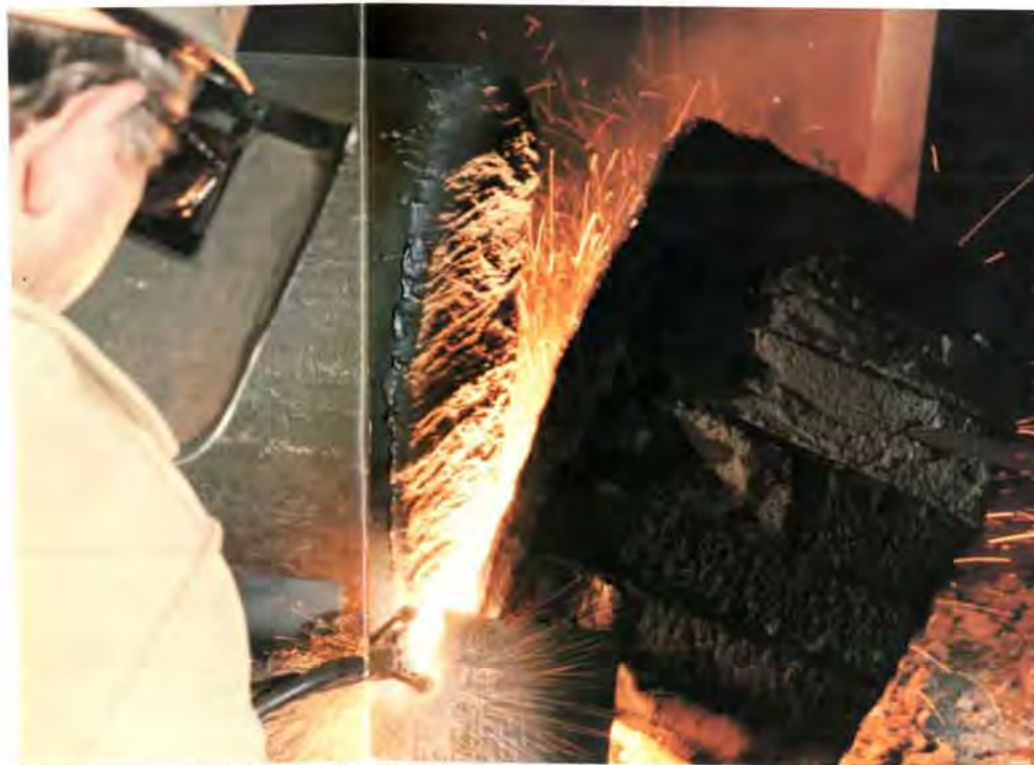
Sonderfall: Der Starschneidbrenner trennt bis zu 750 Millimeter dicke Rundblöcke durch Pulverzugabe
