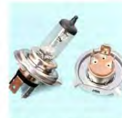
Der Justiering von Bilux-Lampen wird mit dem Lampensockel an 6 Stellen verschweißt
