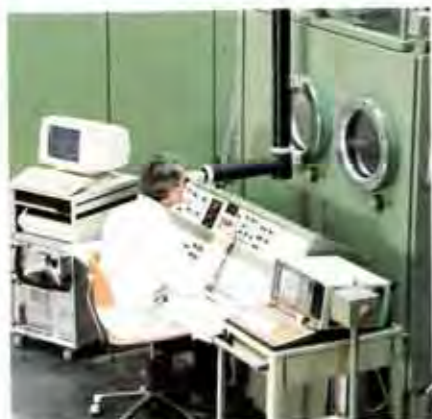
Über ein Mikroskop wird das Werkstück eingerichtet, bevor es der Elektronenstrahl CNC-gesteuert schweißt
