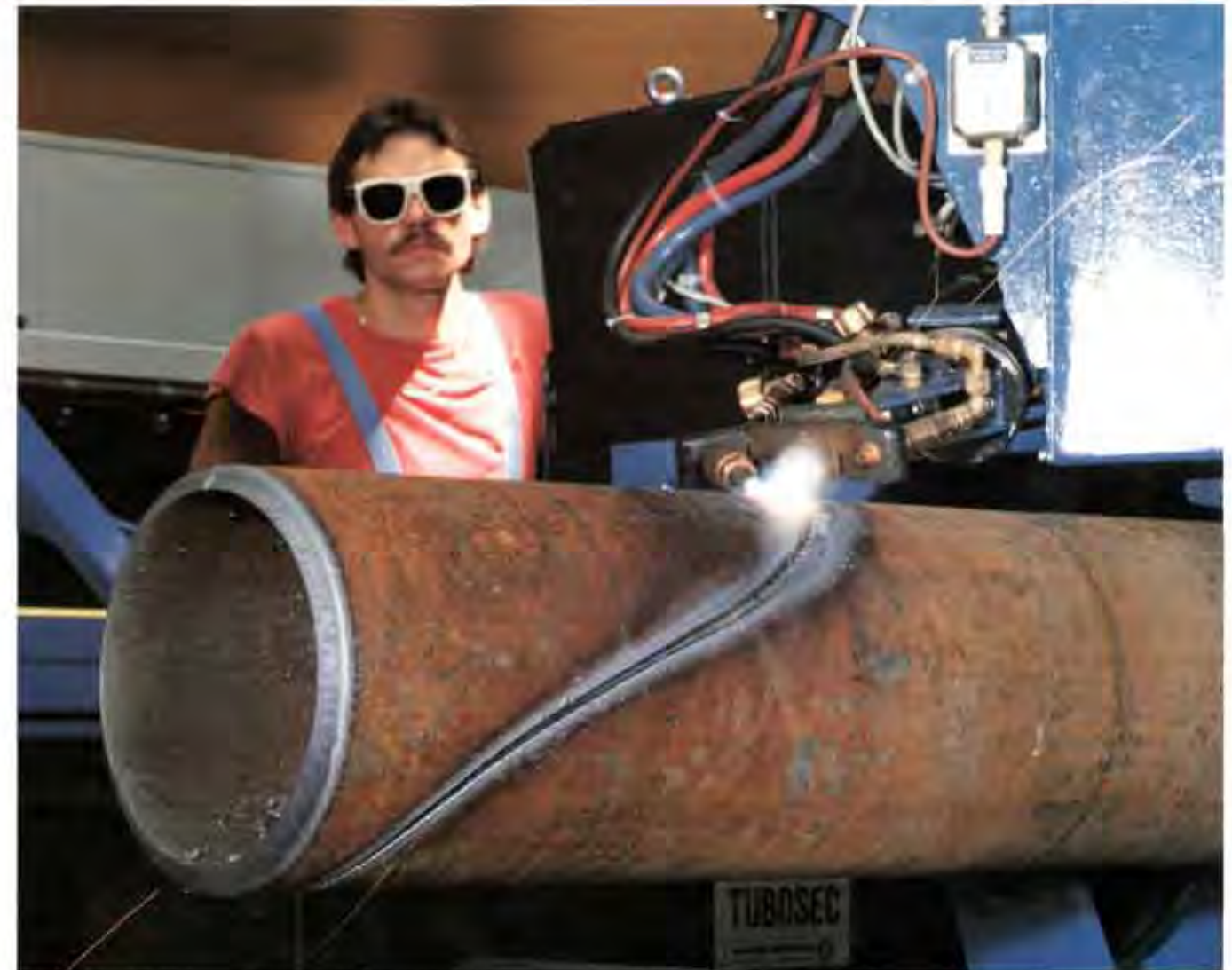
Patent: Die Schnitte an Rohren und Profilen sind bei der neuen CNC-Brennschneidmaschine programmierbar
