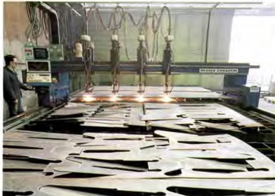
Sparsam: Optimierte Brennschneid-Software führt mit Hilfe von Personalcomputern zu minimalem Verschnitt
