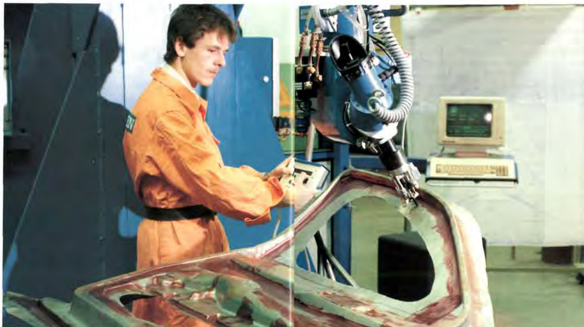
Die Schneidkontur einer Autotür wird vom Teachkopf aufgenommen und gespeichert,
