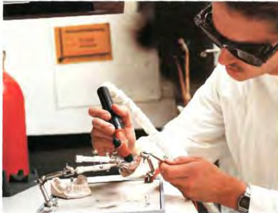
Zahntechniker nutzen das moderne Verfahren des Mikroplasmenschweißens für Klammer-, Bügel- und Plattenverbindungen
