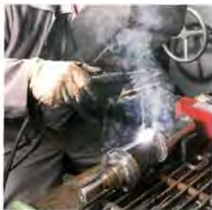
Stabelektroden für das Auftragschweißen einer Welle müssen korrosions- und hitzebeständig sein
