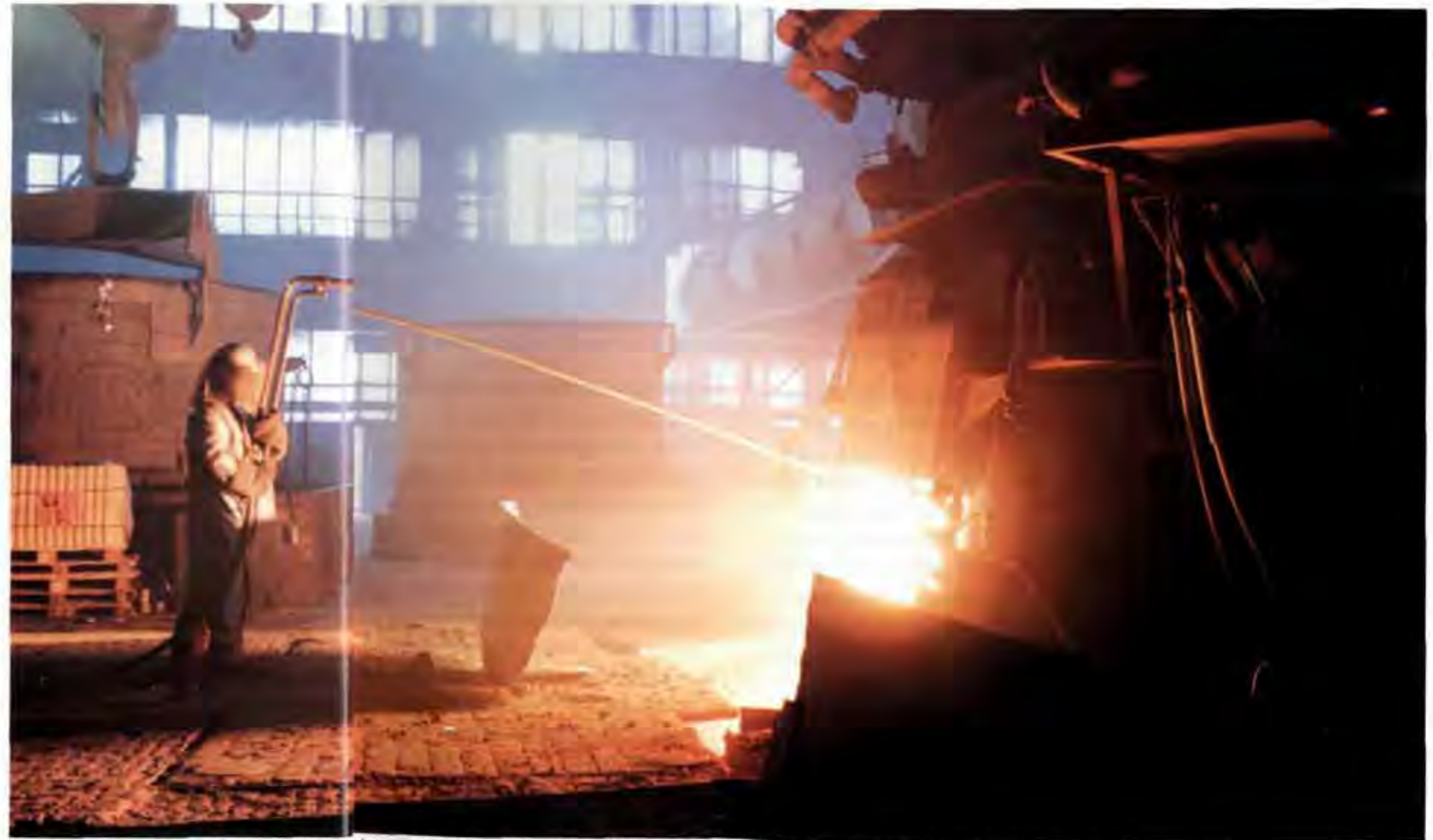
Frischen im Lichtbogenöfen: Sauerstoff, in Lanze eingetragen, beschleunigt den Schmelzvorgang und erhöht die Reinheit der Schmelze
