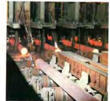
Automatisiert: wirtschaftliches Brammenschneiden mit Autogenbrennern
