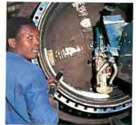
Das Unterpulverschweißen ist eines von vielen Verfahren aus dem Angebot der Fedgas in Südafrika
