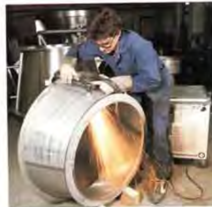
Handlich: Plasmaschneidergeräte erleichtern Ausschnitte an Chromnickelstählen
