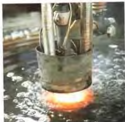
Umweltschonend: Das thermische Schneiden unter Wasser schützt vor Lärm, UV-Licht, Staub und Gasen
