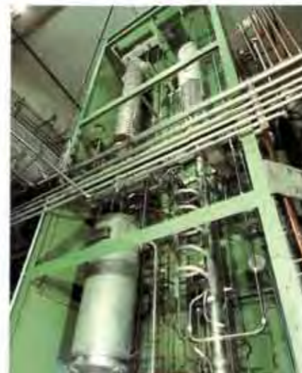
Silan-Nachreinigung: Prozeßgase wie Silan sind zum Herstellen von Halbleiter-Chips erforderlich
