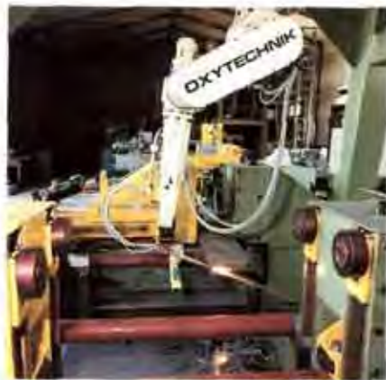
Oxytechnik entwickelte für eine Werft eine automatische Stahlverarbeitungsline mit Schneidroboter
