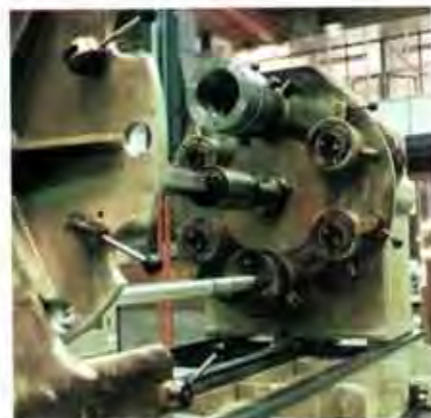
Jeder der 6 Rohrzylinder mit 270 mm Rohrdurchmesser wird 45 mm tief geschweißt
