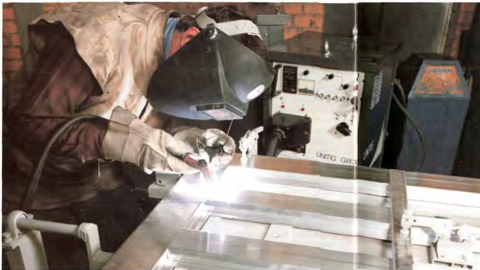
Der Rahmen aus Strangpreßprofilen für eine Flachpalette entsteht unter dem WIG-Lichtbogen
