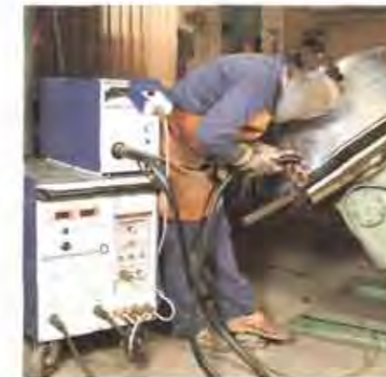
Spritzerarm ist das MAG-Impulsschweißen von Kehlnähten an einem Containerteil aus Chromnickelstahl
