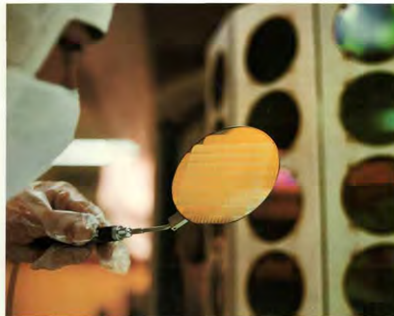
Schaltschemas werden fotografisch auf Siliziumscheiben geprägt, unterstützt durch Ätzgase
