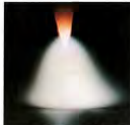
Mit Argon/Helium-Gemischen läßt sich die Schweißgüte in vielen Fällen verbessern
