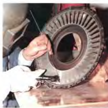
Sehr wirtschaftlich gelingen Reparaturen mit Hilfe des Mikroplasma-schweißens am Schrägflügel einer Flugzeugturbine.
