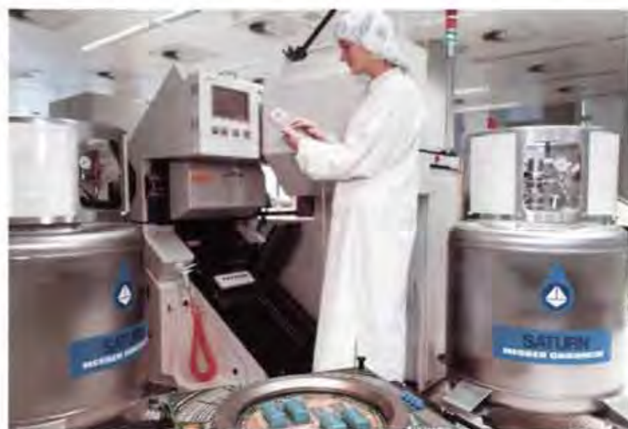
Mit flüssigem Stickstoff aus superisolierten Behältern testet Siemens im Reinraum-labor Chips aus der 4-Mega-bit-Fertigung auf Funktions- und Kältebeständigkeit
