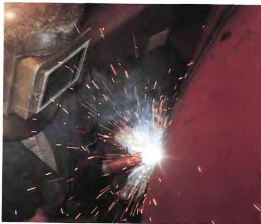
Hohe Qualität der Schweißnähte erzielt ein Hersteller von Betonmischbehältern mit niedriglegierten Metallpulver-Fülldrähten
