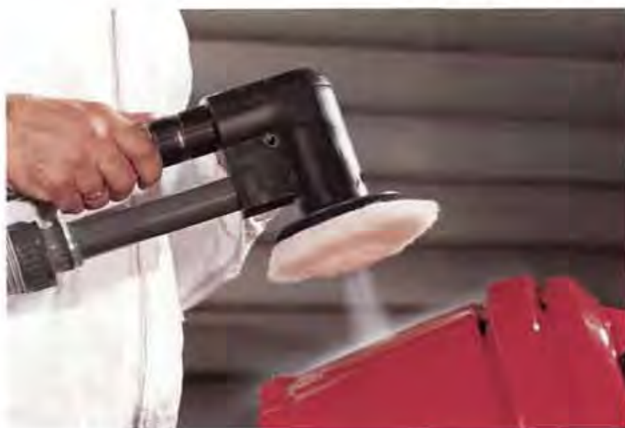
Das Druckluft-Polieren mit Kaltgas erlaubt das Ausbessern von Fehlstellen im Lack von Kunststoffteilen, zum Beispiel bei Kraftfahrzeug-Lackierbetrieben
