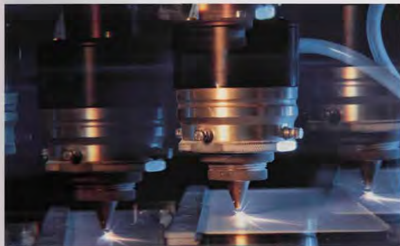
Eine neue Anwendung für unsere Laser-Systemtechnik bei Hoechst CeramTec ist das Schneiden, Bohren und Ritzen von Keramikwerkstoffen für die Elektronik-industrie.
