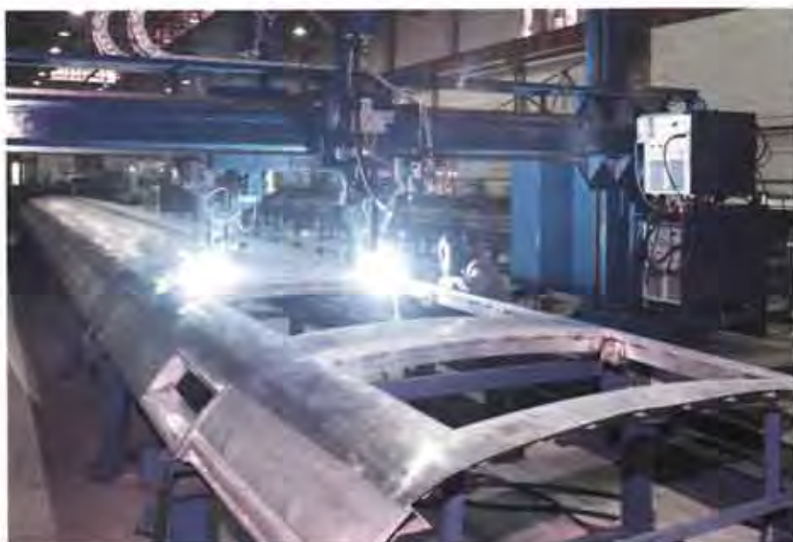
Wirtschaftlich: Die Längsnähte von Dach und Seitenwand für Eisenbahnwaggons werden mit Portalmaschinen bei der Linke-Hofmann-Busch GmbH mechanisiert geschweißt
