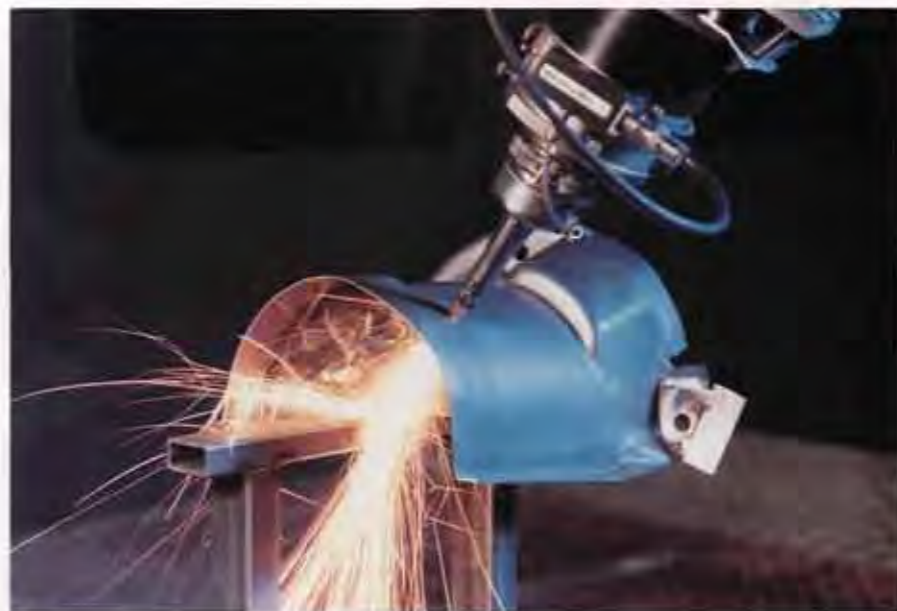
Das dreidimensionale programmgesteuerte Laserschneiden ersetzt im Vorserienbau der Automobilindustrie die Handarbeit. Schnell und genau schneidet der gebündelte Lichtstrahl Getriebegehäuse und andere Teile.
