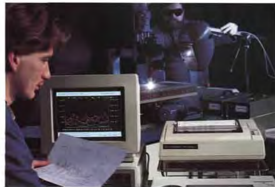
Die rechnergestützte Schweißrauchmessung im Atembereich des Schweißers zeigt unter anderem, ob der Schweißer den zu seiner Sicherheit richtigen Abstand zum Lichtbogen einhält.
