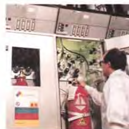
Hochreine Gase und Versorgungseinrichtungen spielen eine Schlüsselrolle bei der 4-Megabit-Chip-Fertigung der IBM Deutschland GmbH. Zum Beispiel ätzen Gase feine Strukturen auf die Siliziumscheiben; Dotergase verbessern die Leitfähigkeit. Ein weiterer Prozessschritt ist das Beschichten mit Fotolack (Bild unten)
