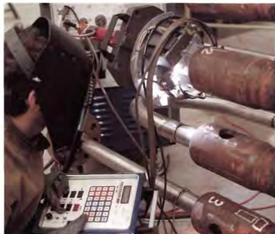
Über anhaltenden Erfolg mit Orbital- und Lichtbogenschweißanlagen berichtete Messer Griesheim Italiana. Vor allem Chemikunternahmen automatisieren die Rohrschweißverbindungen im Apparatebau
