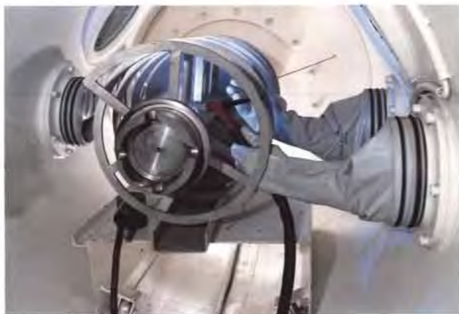
Hochwertige Sonderwerkstoffe wie Titan werden unter Schutzgasatmosphäre in einer Kammer mit WIG-Geräten geschweißt.
