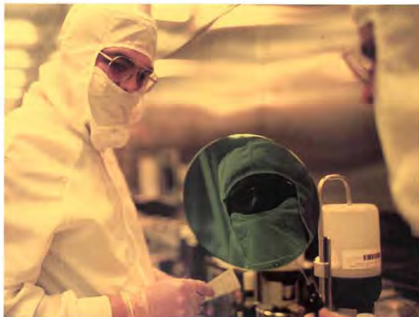
Hochreine Gase und Versorgungseinrichtungen spielen eine Schlüsselrolle bei der 4-Megabit-Chip-Fertigung der IBM Deutschland GmbH. Zum Beispiel ätzen Gase feine Strukturen auf die Siliziumscheiben; Dotergase verbessern die Leitfähigkeit. Ein weiterer Prozessschritt ist das Beschichten mit Fotolack (Bild unten)
