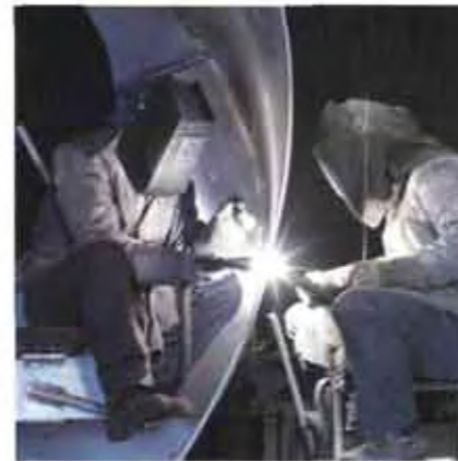
Präzisionsarbeit im Team ist beim beidseitig gleichzeitigen Wolfräm-Inertgas (WIG)-Schweißen von Aluminiumbehältern gefragt. Das Göttinger Unternehmen Weber Anlagenbau erzielt damit Rundnähte, die einer Röntgenprüfung standhalten. Das Schweißen mit hochwertigen Schutzgasen aus Argon und Helium erspart die Nahtvorbereitung.
