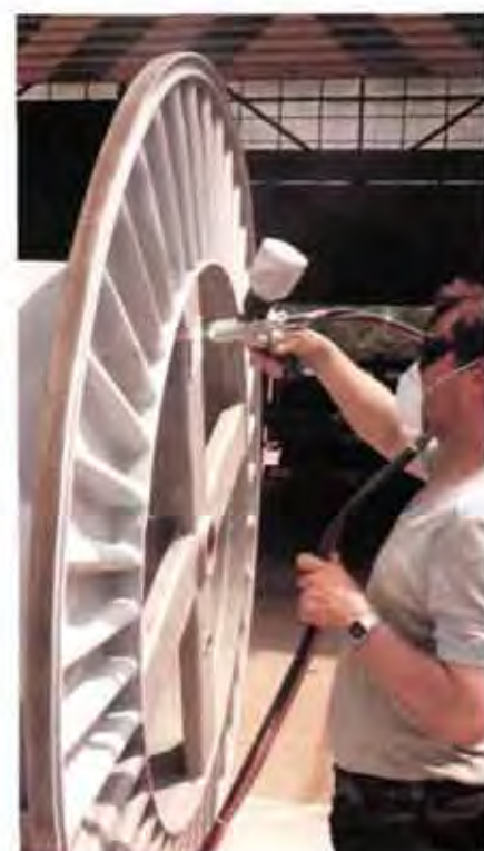
Durch Flammspritzen mit Zink- und Kunststoffpulver werden große Kabeltrommeln vor Korrosion geschützt
