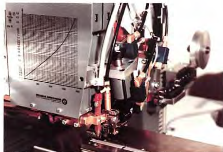
Mit dem mechanisierten, computer-gesteuerten Widerstandsschweißen werden in der Elektronikindustrie Drähte und Medwiderstände verschlossen.
