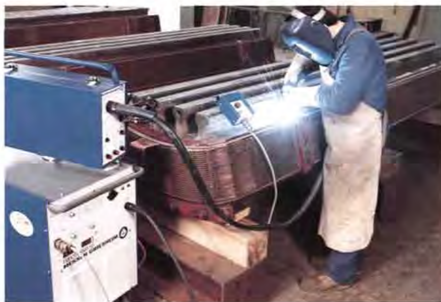
Für MIG/MAG-Schweißungen mit zwei Generatoren nutzt die Schweißwerk AG die Vorteile der Invertertechnik.
