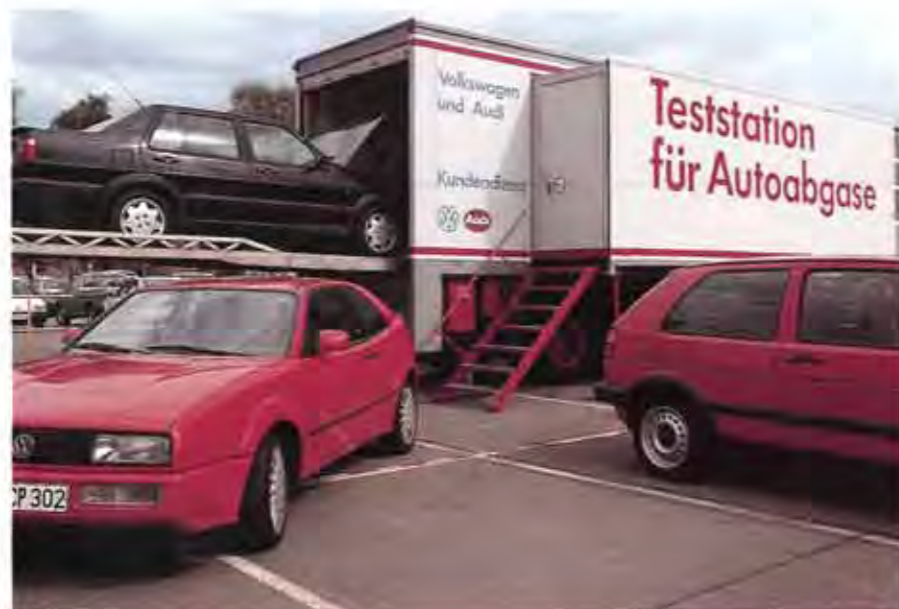
Eine mobile Meßstation dient bei den Unternehmen VW und Audi der Abgasüberwachung von Pkw-Motoren. Mit Hilfe unserer Reinstgasversorgungstechnik wird an Fahrzeugen aus jeder Serie geprüft, ob die Schadstoffgrenzen eingehalten sind.
