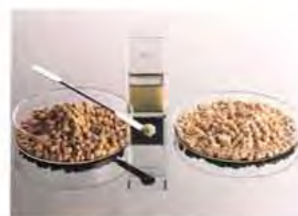
Durch Extraktion mit hochverdichtetem Kohlendioxid lassen sich schonend wertvolle Substanzen aus natürlichen Rohstoffen gewinnen. Hopfenextrakte für den Brauprozess enthalten zum Beispiel nur noch die gewünschten Geschmacksstoffe
