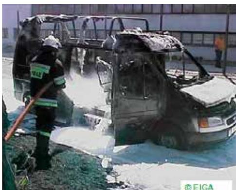
Une fuite de gaz acétylène provenant du robinet d'une bouteille de gaz s'est enflammée à l'intérieur d'un camion de livraison. Le conducteur s'est échappé de justesse. Le véhicule a brûlé en seulement deux minutes.
