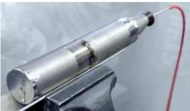
Sintermetall Formierfinger zum Formieren von Rohren
