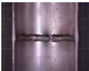
Wurzelschutz mit Innoxline H5
