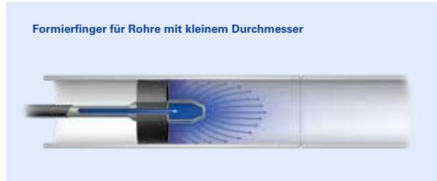
Formierfinger mit Stopfen zum Füllen von Rohren mit geringen Durchmessern
