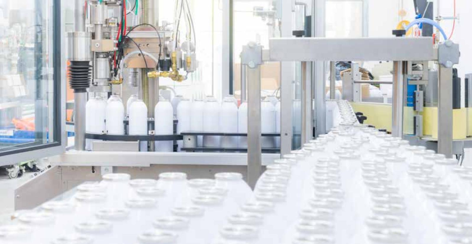
*Remplissage totalement automatisé des cartouches sous pression à Lenzburg*
