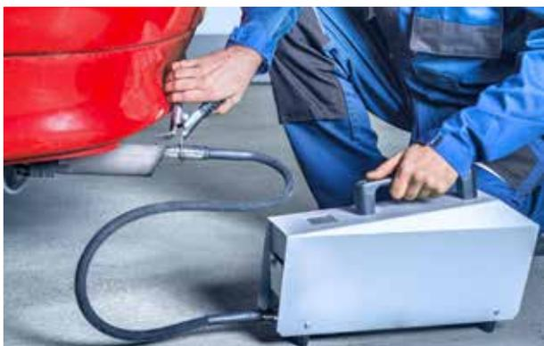
*Contrôle des gaz d'échappement d'un véhicule*
