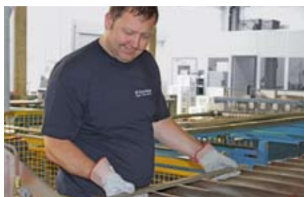
Lorenz Thalmann prüft die Heizstäbe nach dem Glühen im Banddurchlaufofen.
