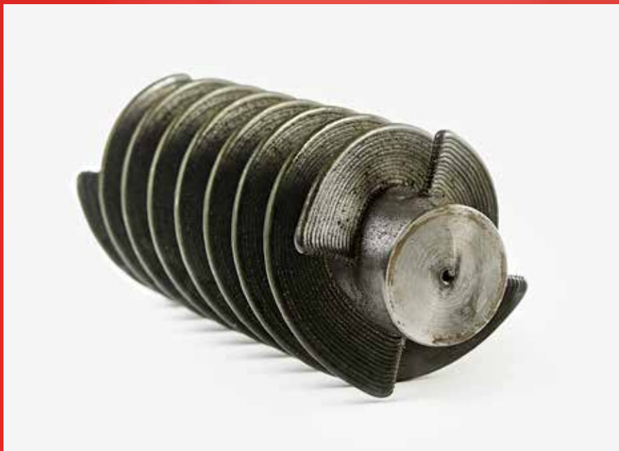
Auch komplexe Metallteile lassen sich heute mit einem 3D-Verfahren herstellen.
