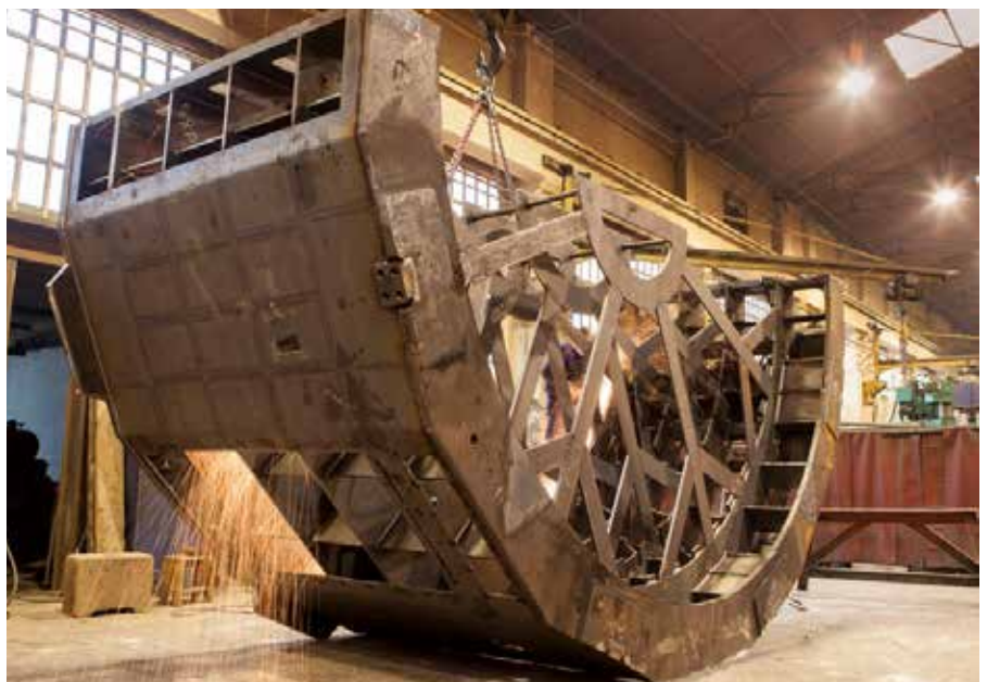
Teil eines Generatorgestells für ein Wasserkraftwerk mit einem Durchmesser von fünf Metern
